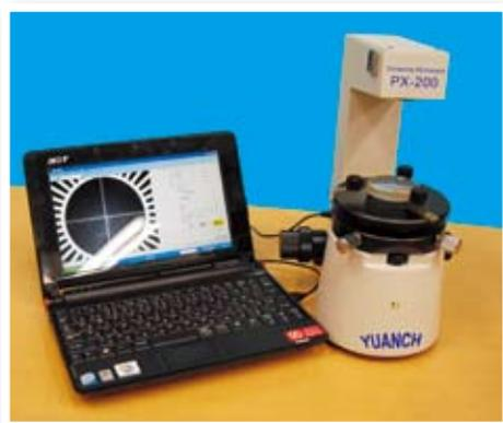
主机配置手提电脑，画面处理后更清晰，达到高精度偏芯测定。数字表示偏芯测量值，并同时判定是否合格。
